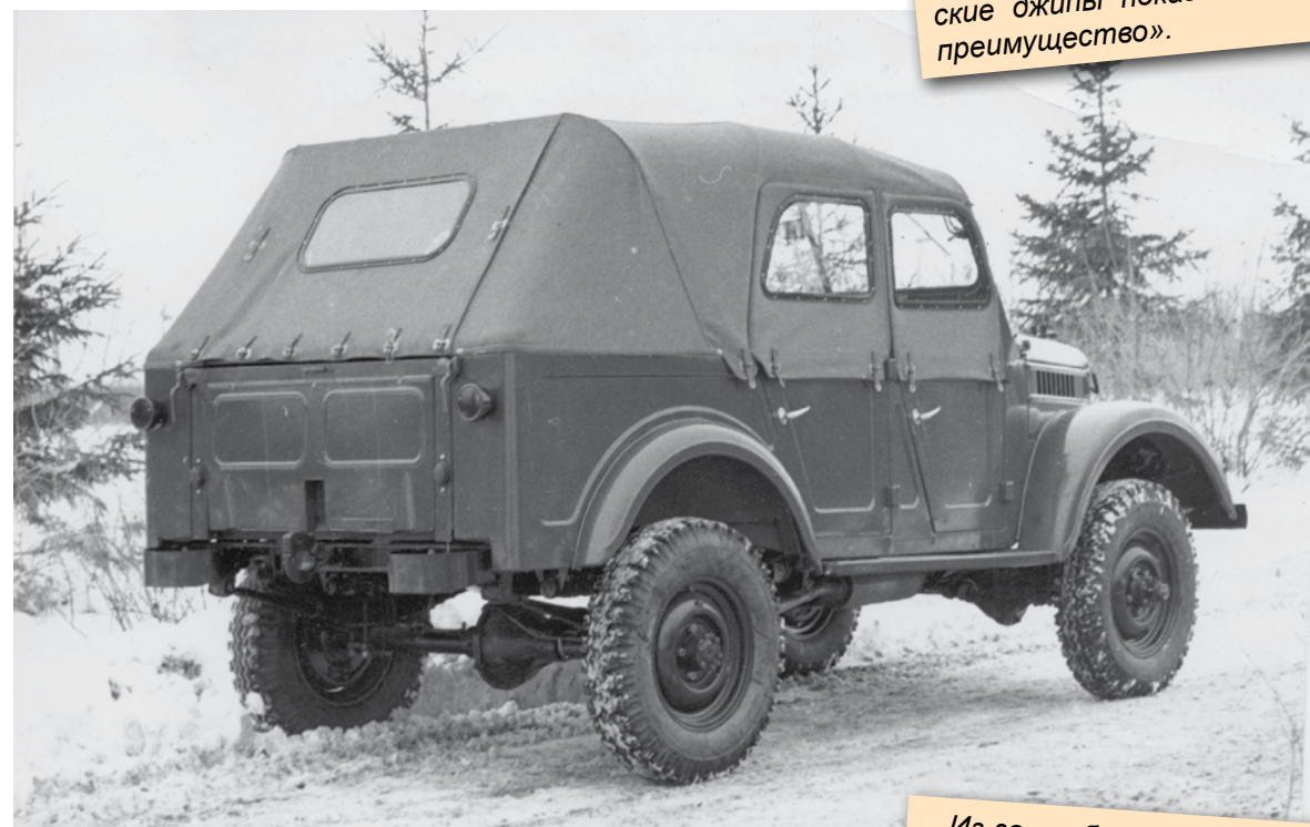
▶ Автомобиль «ГАЗ-69А-68». Заднее окно большего размера.
