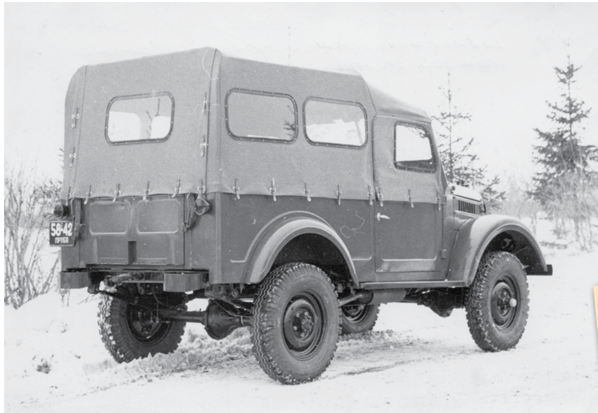
▶ Автомобиль «ГАЗ-69-68». Заднее окно большего размера и два дополнительных боковых окна на каждой стороне.
