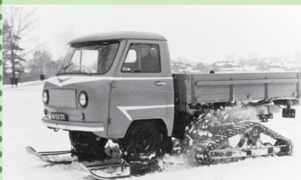
Снегоход во время испытаний своим ходом добрался от Омска до Ульяновска. Также на испытаниях было установлено, что переход с колесной ходовой части на полугусеничную занимает в полевых условиях около одного часа при работе двух человек.
