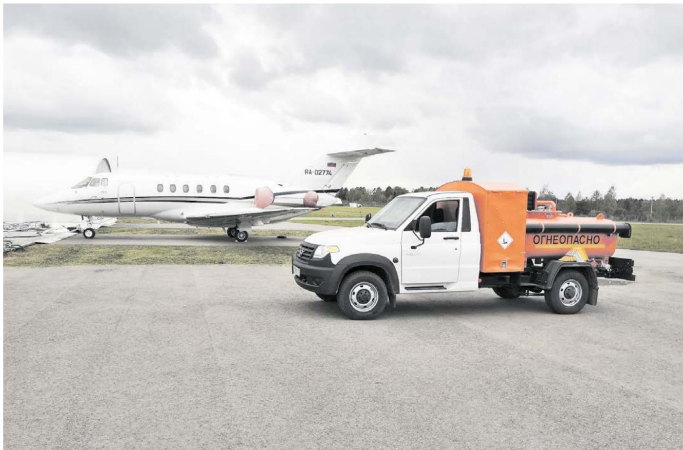
На базе УАЗ создан новый универсальный топливозаправщик. В зависимости от варианта оснащения, модель позволяет оперативно осуществлять обслуживание и заправку автомобилей, маломерных речных средств передвижения или воздушных судов сверхлегкой авиации. Спецверсия, разработанная партнером бренда, подмосковной компанией «Вектор», полностью экипирована в соответствии с требованиями женеvского соглашения о дорожной перевозке опасных грузов (ДОПОГ).
