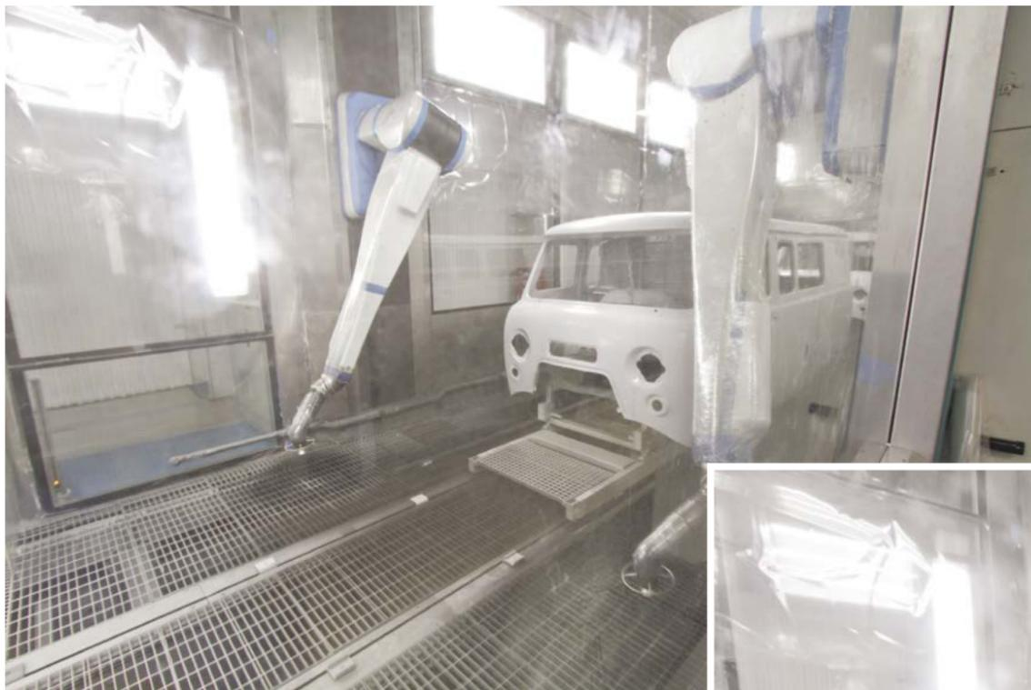
качество переноса материала, поскольку при его использовании почти все заряженные частицы краски прилипают к поверхности кузова, за счет чего коэффициент переноса материала увеличивается до 90%.
