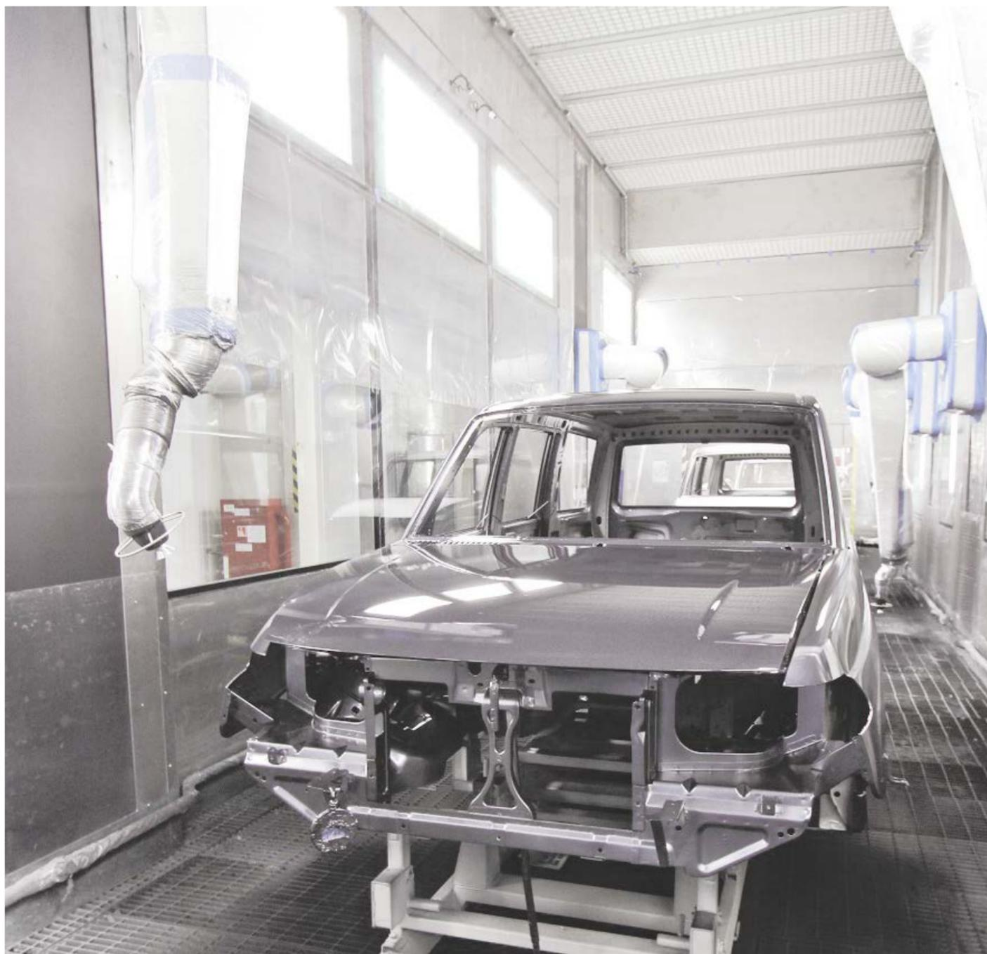
В рамках инвестиционного проекта в цехе окраски EISENMANN проведена модернизация двух окрасочных роботов, в результате чего пневматический способ нанесения краски заменен на электростатический. Это позволит снизить себестоимость окраски кузовов за счет повышения эффективности нанесения базовых эмалей.
