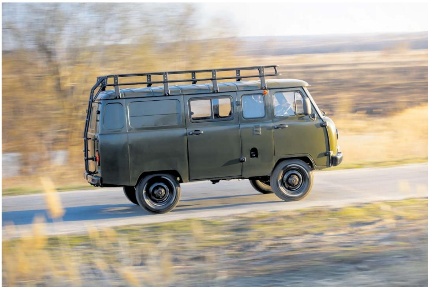
В соответствии с достигнутыми ранее договоренностями ООО «УАЗ» поставит компании «Ягоды Карелии» в общей сложности 100 микроавтобусов СГР. Автомобили в девятиместной модификации УАЗ 220695-550-04 оснащаются рядным 4-цилиндровым бензиновым двигателем объемом 2,7 литра, 5-ступенчатой МКПП и подключаемым полным приводом. По требованию заказчика все они имеют защитный цвет кузова, оборудованы шаровым тягово-сцепным устройством
