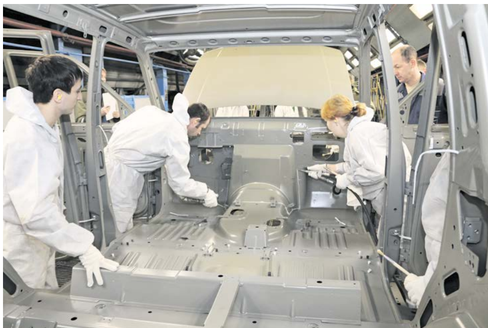
► Нанесение мастики на участке грунтования
