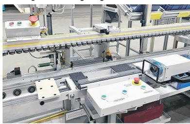
Фаис изменил порядок кнопок на пульте управления. Одну из рабочих кнопок он перенес в правую сторону, чтобы избежать ее случайного нажатия.
