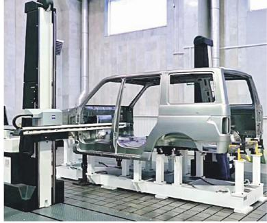
и моторный отсек. Эта машина обеспечивает высокую точность измерений и позволяет выявлять даже малейшие несоответствия.
