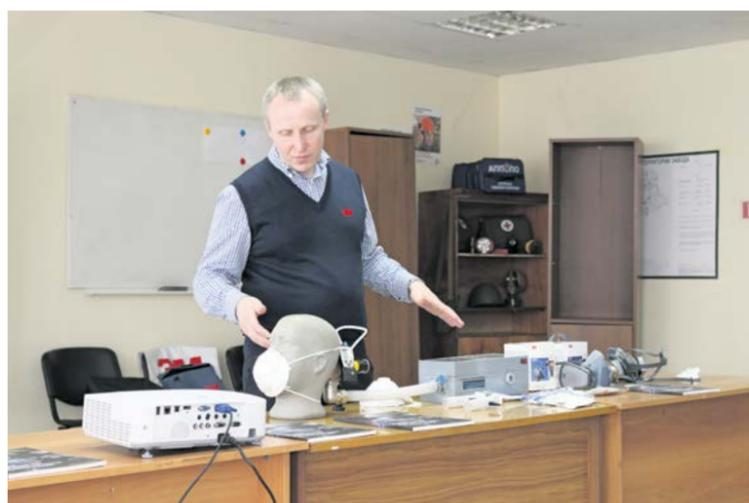
Шеффилда. С ее помощью была продемонстрирована работа респиратора при различных условиях: эффективность фильтра, плотное прилегание за счет 3-х панельной конструкции. Был измерен коэффициент свободного дыхания.
