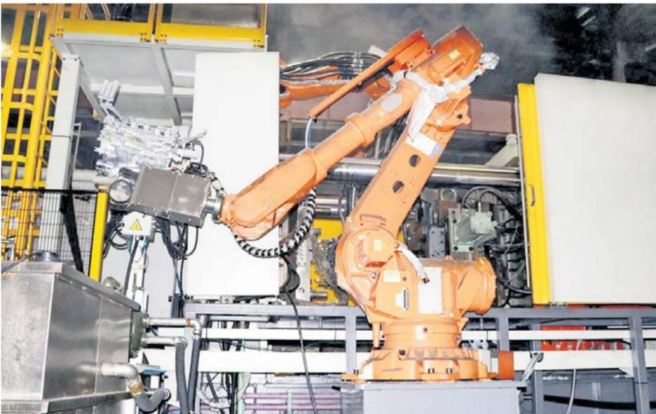
**ООО «СОЛЛЕРС Производство Трансмиссий» локализовало производство алюминиевых картеров КПП, включая технологические операции по литью и механической обработке компонентов. Индустриальным партнером проекта выступает литейный завод «РосАлит» в Заволжье, на площадке которого налажено серийное производство компонентов.**
