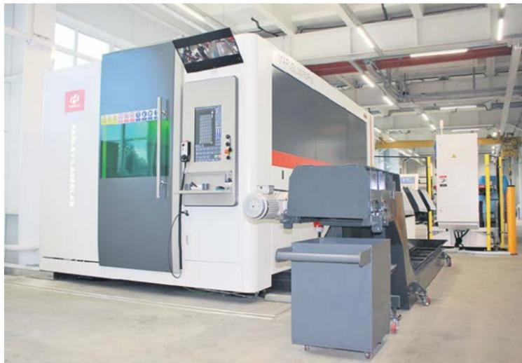
Лазерное оборудование, использующее в процессе резки сжатый воздух, обеспечит высокое качество кромки и улучшит характеристики выпускаемой продукции. Запуск участка увеличит объем выпуска готовой продукции и повысит эффективность использования материала благодаря оптимизации раскроя металла на листе. Высокий экономический эффект
