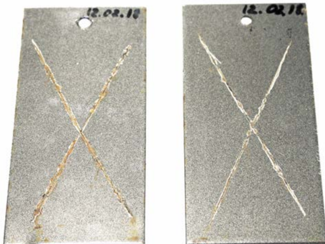
► Образцы металла после испытаний в камере солевого тумана. Слева – обработанный прежним грунтом, справа – грунтом нового поколения компании PPG.
