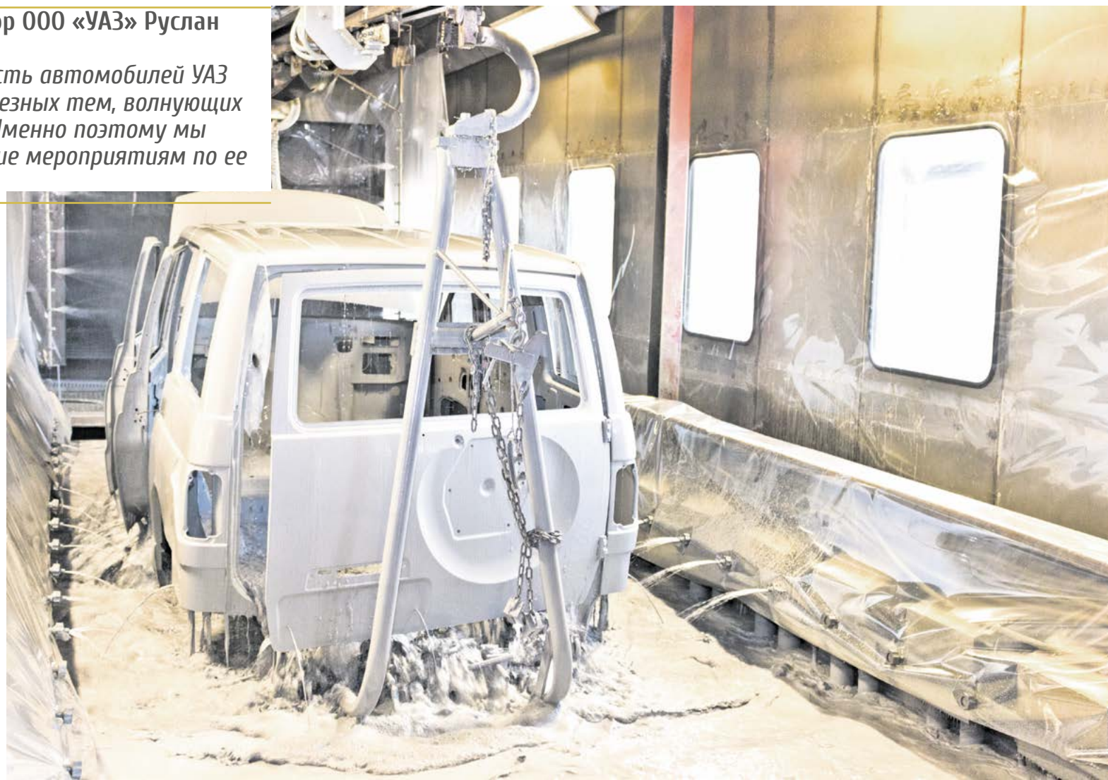
► Кузов УАЗ ПАТРИОТ поднимается из ванны катафореза. Участок первичного и вторичного грунтования окрасочного производства.
