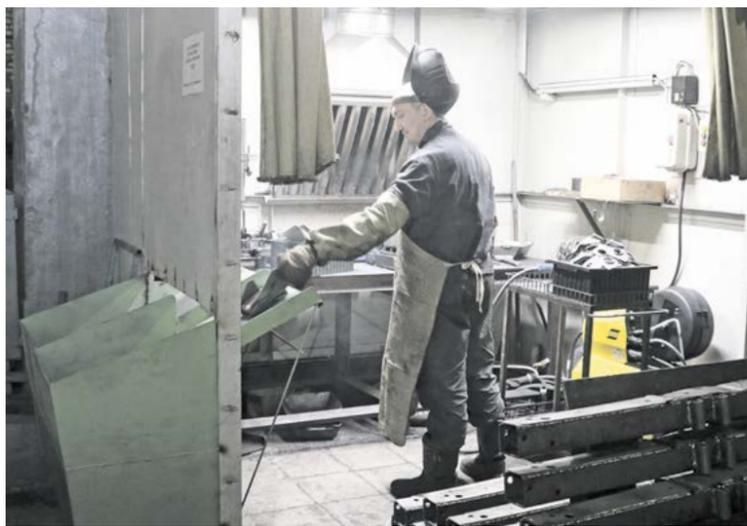
► **Евгений Селиверстов демонстрирует работу внедренных склиза и деталеприемника, которые исключают лишние переходы и затраты времени. (Ранее сварщик был вынужден выходить из кабины, чтобы опустить деталь в контейнер).**
