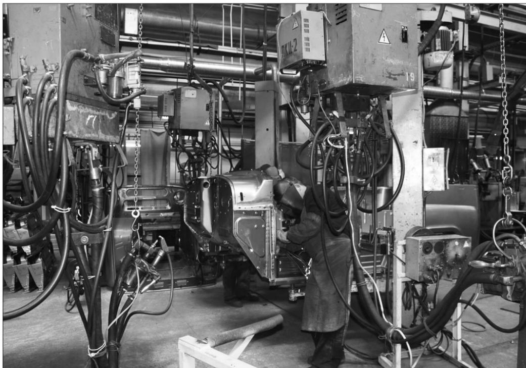
В настоящее время проводится модернизация автоматических линий сварки основания, боковин и линии сварки кузова для выпуска обновленного UAZ Patriot, а также некоторых сварочных кондукторов. Выполнена модернизация кондукторов сварки распашной задней двери, рамок боковин и крыльев кузова. Под четким руководством технологов в июле были сварены первые опытные пять кузовов UAZ Patriot-2014. Согласно утвержденному графику к концу
