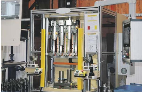
«Промежуточный вал – один из ключевых узлов МКПП, который гарантирует надежность работы агрегата. Три новые единицы прессового оборудования обеспечат высокую точность запрессовки компонентов промежуточного вала – синхронизаторов и шестерен, автоматизируют технологический процесс, что позитивно скажется на качестве коробок передач легких коммерческих автомобилей Sollers», – отметил генеральный директор ООО «СОЛЛЕРС Производство трансмиссий» Ильнур Сахабиев.
